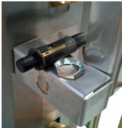
4. Durch den neuen Piezo ersetzen, die Fläche der Mutter muss handfest auf dem Plattenträger aufliegen.
