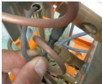
3. Lösen Sie die Blechmutter auf der Rückseite und entfernen Sie den Piezo.
