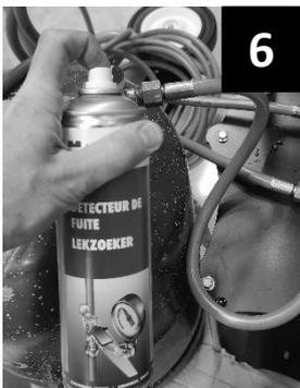
6. Vérifier avec de l'eau savonneuse (spray à bulles) tous les raccords entre les tuyaux, vannes de sécurité et le détendeur
