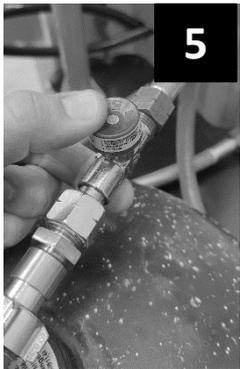
5. Appuyez sur le(s) bouton(s) rouge(s) des valves de sécurité de(s) bouteille(s) pendant quelques secondes pour amorcer le gaz dans les tuyaux.
