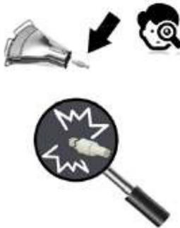
Démonter la bougie à l'aide d'une pince plate. Contrôler si la céramique est fissurée.
