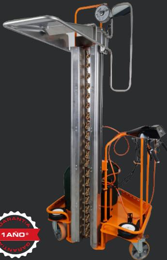
El Turbopack es una columna retracción móvil, montada sobre un carro fácilmente desplazable. Esto permite al operador retraer la carga a cualquier punto de la zona de envío, lo que resulta muy práctico para evitar el desplazamiento de cargas inestables.
